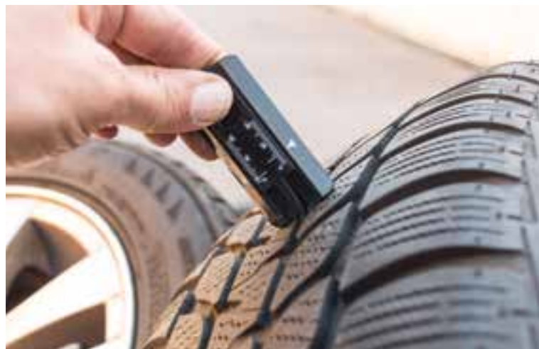
È importante controllare sempre la profondità del battistrada. Le caratteristiche di guida rilevanti per la sicurezza sono compromesse con l'usura degli pneumatici.
